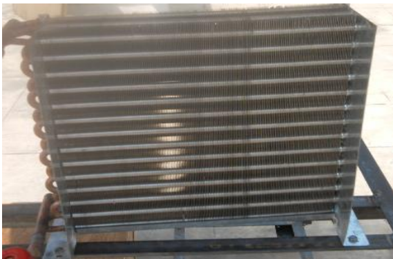
Fig- 5: Actual photo of Condenser
