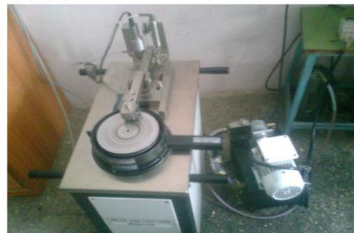
Fig.1- Pin-On-Disk Machine
