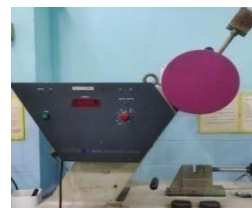
Fig.3 b:- Izod Impact Testing
